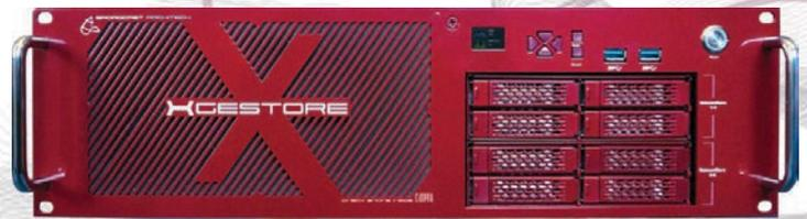
XGESTORE a été conçu dans le but d'être l'écosystème connecté d'ingest universel le plus compact, le plus fiable et le plus performant du marché. En seulement 3U, XGESTORE enregistre 16 canaux nativement dans tous les codecs existants et dans tous les formats, de la SD à la 8K HDR, et ce quel que soit la source : SDI, IP, Fichiers et tout type de carte de caméra
